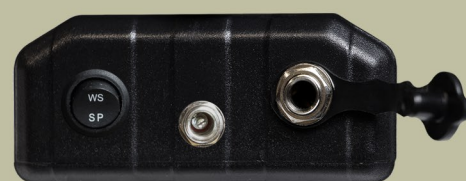
Bateriový box s přepínáním provozu na sluchátka nebo reproduktor
